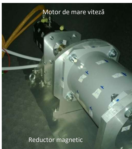
Fig.A2. Propulsie electrică: cu moto-reductor de mare viteză (stânga), cu/fără transmisie mecanică, sau motoare-roată (dreapta).
