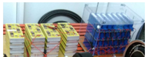
Fig.A6 Sursă hibridă: baterie-ultracondensatori.
