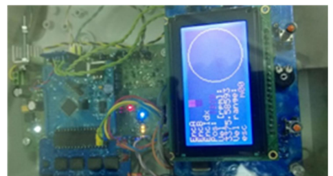
Fig.A7 Electronică detecție/afișare poziție rotor.
