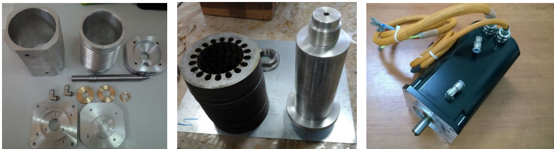
Figura 2. Prototip de MSMP de mare viteză : parte inactivă (stânga), activă (mijloc) și ansamblu (dreapta).
