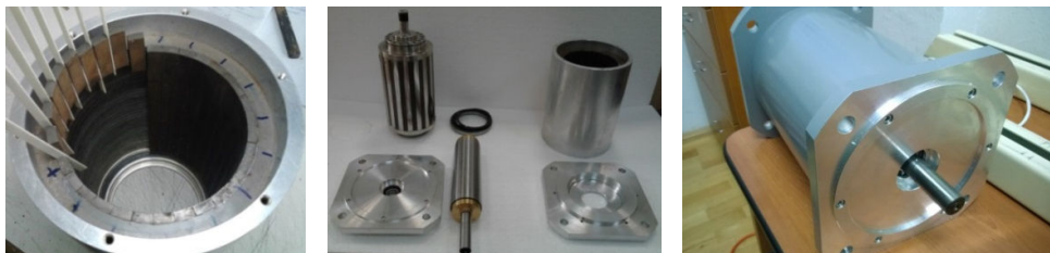
Figura 4. Prototip de reductor magneti cu raport de transmisie 1/16 : componente constructive și ansamblu.
