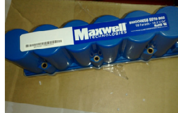
Grup de ultracondensatoare de 16.2 Vcc și 58 F pe celulă.
