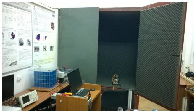
Figura 3. Stand experimental inclus în încăperea de testare cu protecție mecanică și izolare fonică pentru testarea MSMP de mare viteză,.
